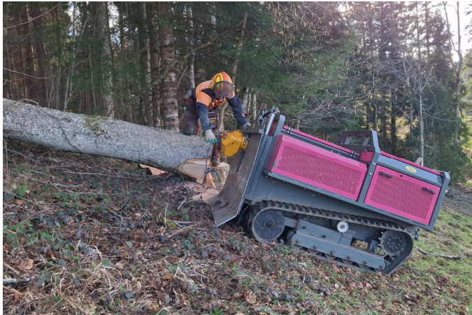
Abb. 1: Der Einsatz von Forstmaschinen wie hier mit einer Forstraupe auf PC73 Schönegeten ist im steilen Gelände häufig notwendig.
